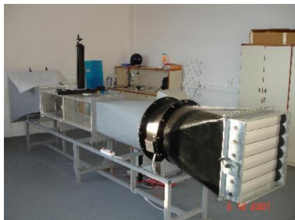
Εικόνα 2. Αεροσήραγγα διατομής 0.35 \times 0.35 \text{ m}^2 .
