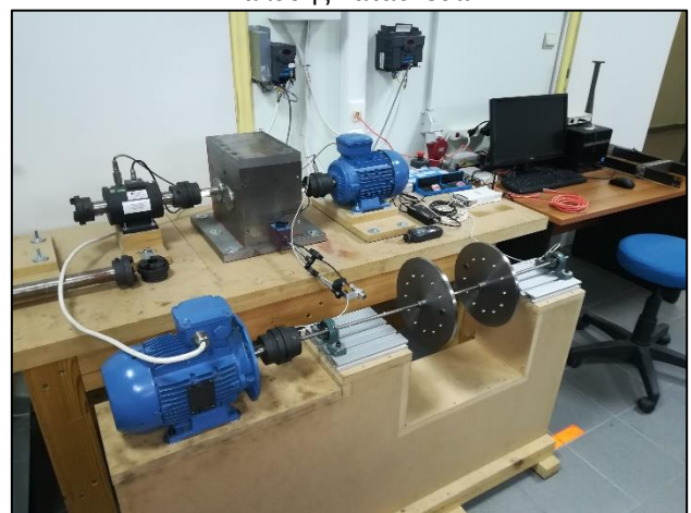
Test Rig για την μελέτη της δυναμικής συμπεριφοράς στροφένων και επίδειξη ζυγοστάθμισης
