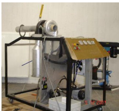
Εικόνα 5. Η διάταξη δοκιμής αεριοστροβίλου.
