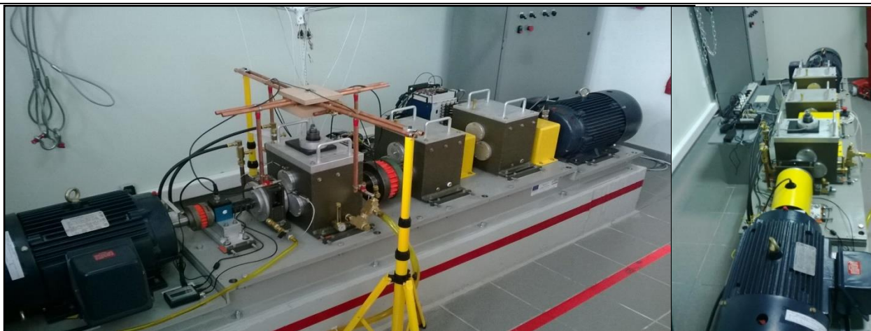
Πρότυπη Πειραματική Διάταξη Διάγνωσης Πρόγνωσης Βλαβών Συστημάτων Μετάδοσης Κίνησης, Powertrain Simulation and Fault Detection Experimental Device [SpectraQuest Inc.]
