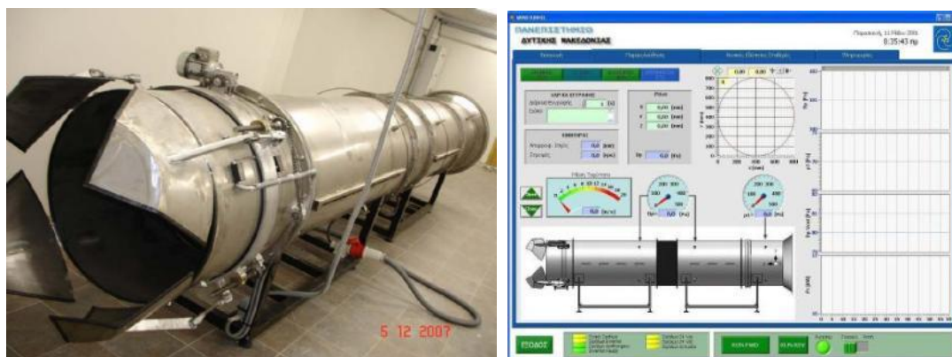
Εικόνα 4. Η μεγάλη διάταξη δοκιμής ανεμιστήρων και το γραφικό περιβάλλον του λογισμικού χειρισμού.
