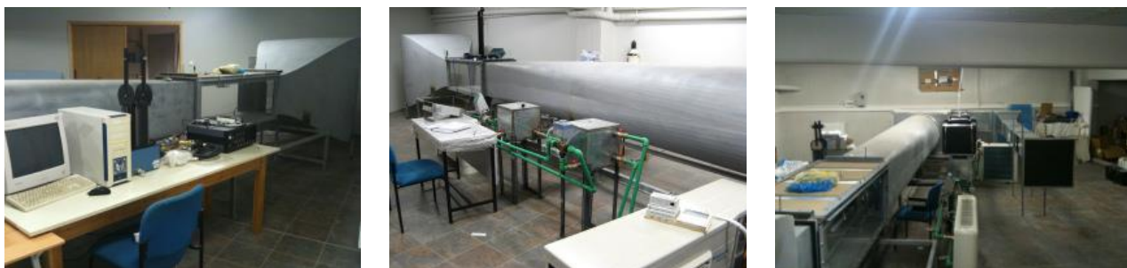
Εικόνα 3. Αεροσήραγγα διατομής 0.50 \times 0.50 \text{ m}^2 και προέκταση μελέτης εναλλακτών.
