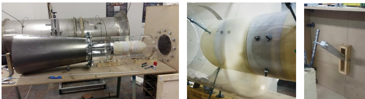
Εικόνα 8. Η πλήρης διάταξη δοκιμής στροβίλου Wells, ο στρόβιλος και το έμβολο.
