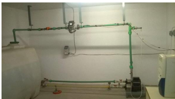
Εικόνα 7. Η διάταξη δοκιμής φυγοκεντρικών αντλιών και το σύστημα ελέγχου της.
