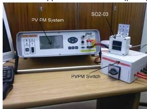
Φορητή μονάδα πιστοποίησης λειτουργίας φωτοβολταϊκών πλαισίων (PVPM)
