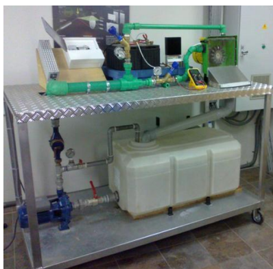
Εικόνα 6. Η πειραματική διάταξη υδροστροβίλου Pelton.
