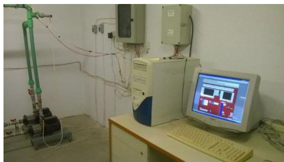
Εικόνα 7. Η διάταξη δοκιμής φυγοκεντρικών αντλιών και το σύστημα ελέγχου της.
